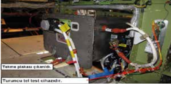
Boeing 787 Ana Pil Muhafazası Basınç Patlama Diski
